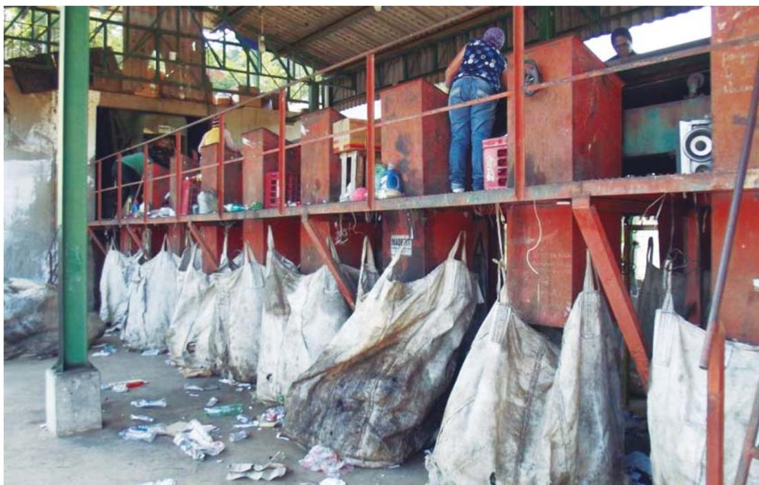
Figura 2 - Foto da esteira de triagem da Usina de Triagem e Reciclagem de Viçosa.
