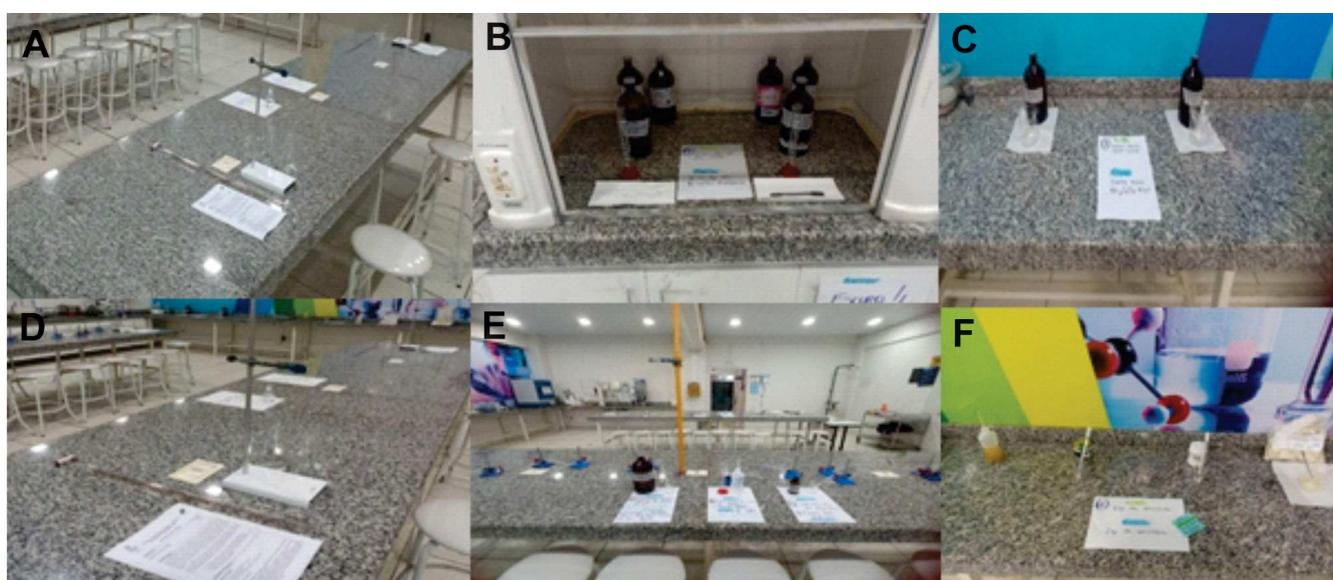
Figura 2 - (A) Bancada preparada com as vidrarias necessárias e roteiro impresso; (B) Reagentes para uso em capela; (C) Reagente para preenchimento das buretas; (D) Reagente para procedimento do índice de acidez; (E) Reagentes em sequência para procedimento de peróxido e (F) Amostras de óleos a serem analisadas.
