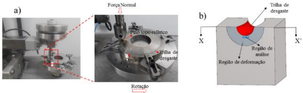
Figura 2 – a) Tribômetro e configuração experimental do ensaio de desgaste por deslizamento do tipo PSD; b) região de análise da trilha desgastada para avaliação da deformação induzida após PSD.
