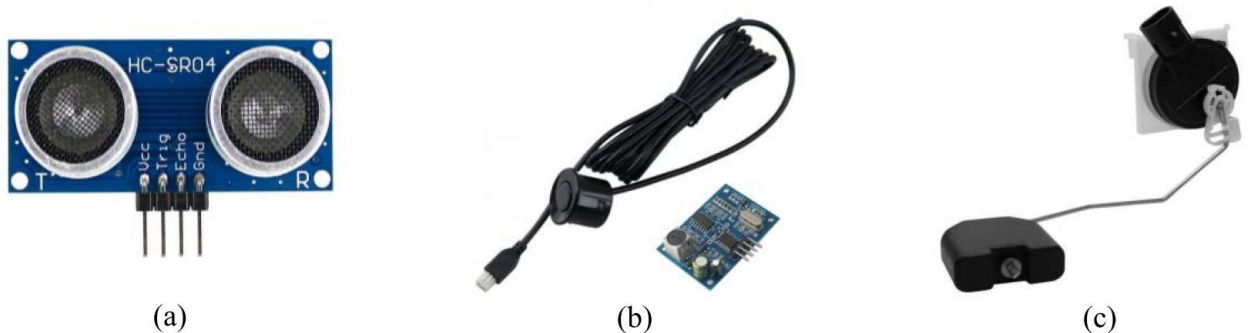
Figura 3 - Sensores para medição com melhor precisão: (a) sensor ultrassônico de baixo custo; (b) sensor ultrassônico à prova d'água e; (c) sensor de combustível veicular
