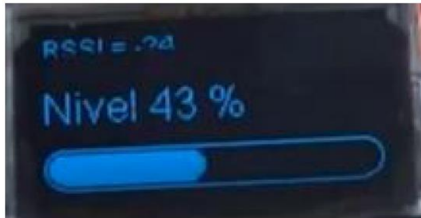
Figura 8 - Nível de água impresso no display OLED do circuito receptor
