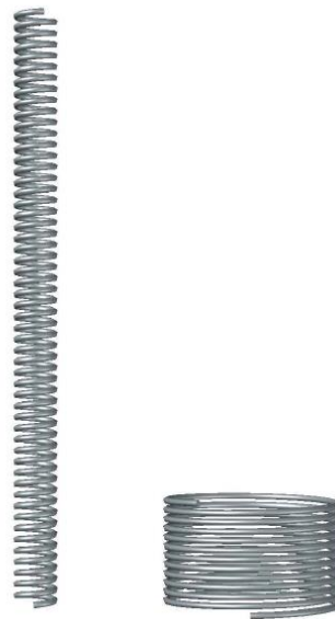
Figura 2 - (a) esquema representativo do circuito hidráulico; (b) esquema representativo dos FTHs testados: o primeiro com D = 0,05 m e o segundo com D = 0,30 m. Fonte: própria autoria.
