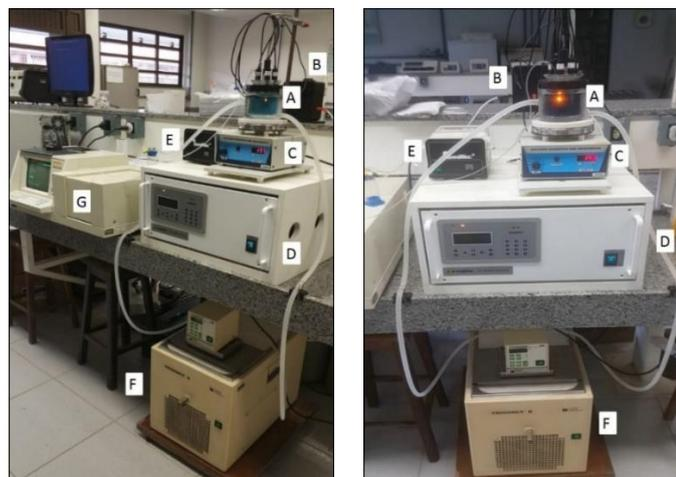
**Figura 4 - Sistema eletroquímico empregado na degradação do ibuprofeno. (A) célula eletroquímica; (B) caixa distribuidora; (C) agitador magnético; (D) fonte de corrente contínua; (E) bomba peristáltica; (F) banho termostatizado; (G) espectrofotômetro. (Fonte: os autores, 2022)**
