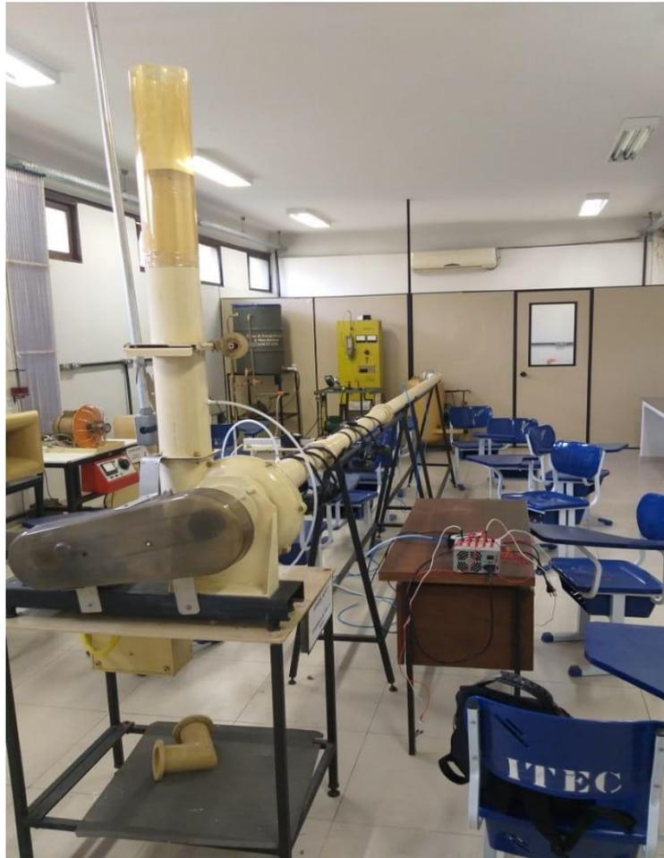
Figura 5 - Túnel de Vento. (Autores, 2022)
