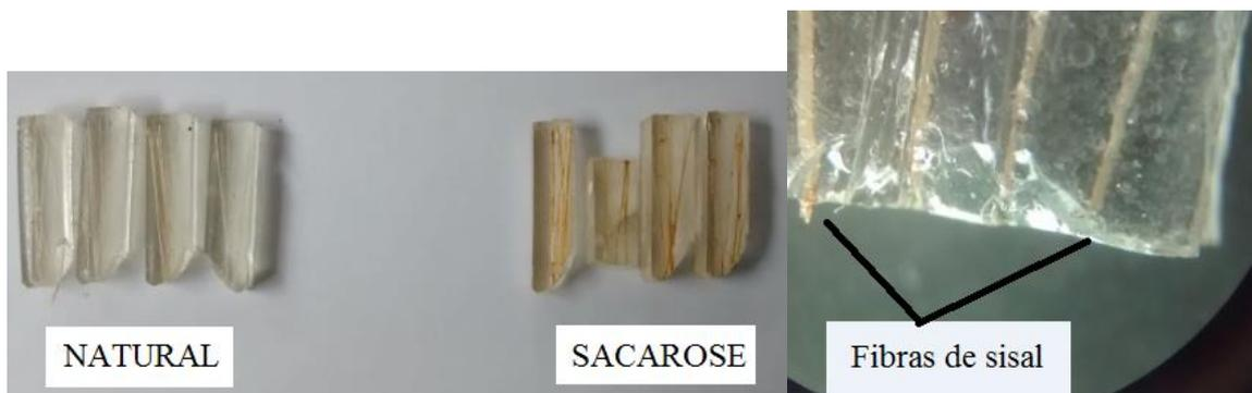
**Figura 5 - Compósitos de poliéster com fibras de sisal, após a ruptura por flexão**
