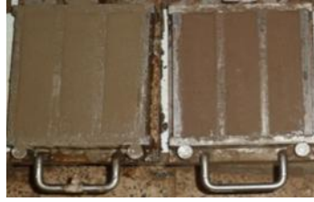
Figure 3 – Eprouvettes de mortiers de 4x4x16cm.
