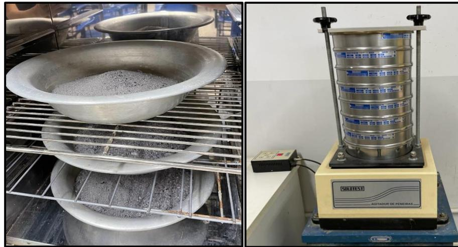
Figura 3 - (a) Secagem do carvão para realização do teste granulométrico; (b) Agitador de peneiras utilizado para peneiramento do carvão.
