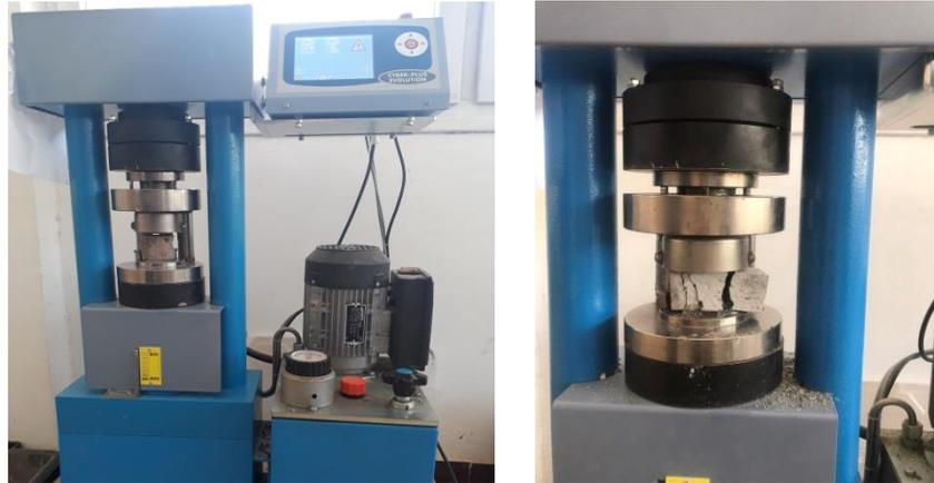
Figure 5 – Presse pour mortier du laboratoire LCTPE à l'université de Mostaganem.
