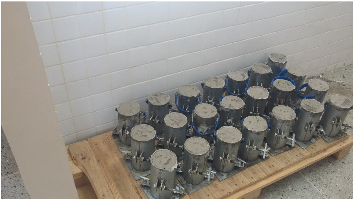
Figura 7 - Moldagem dos corpos de prova de concreto
