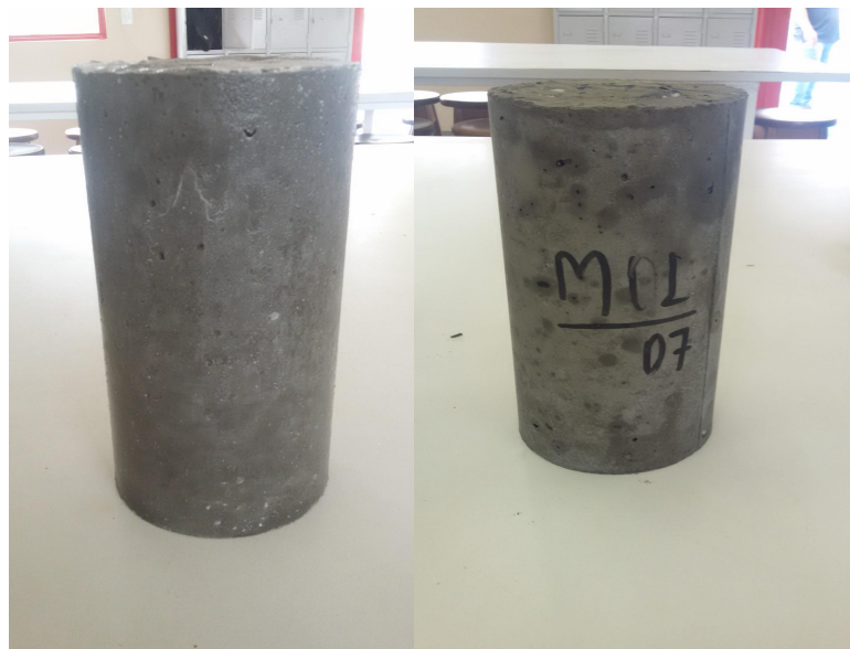
(a) (b) Figura 8 - CP referência (a) e CP com adição da sílica ativa (b)
