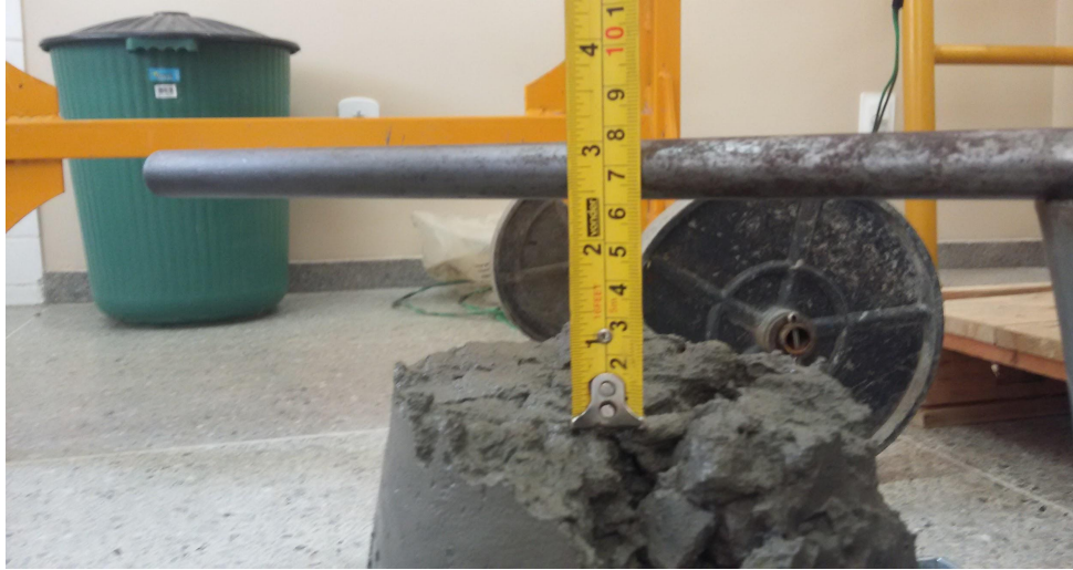
Figura 6 - Abatimento para concreto com adição de 5% de Sílica Ativa
