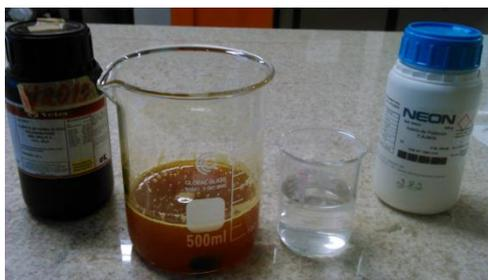
Figura 2: Solução A ( $\text{FeCl}_3$  + água destilada) e solução B (KI + água destilada).
