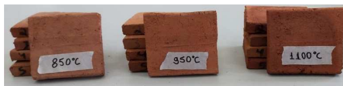
Figura 1 - Corpos de prova sinterizados a 850, 950 e 1100°C.
