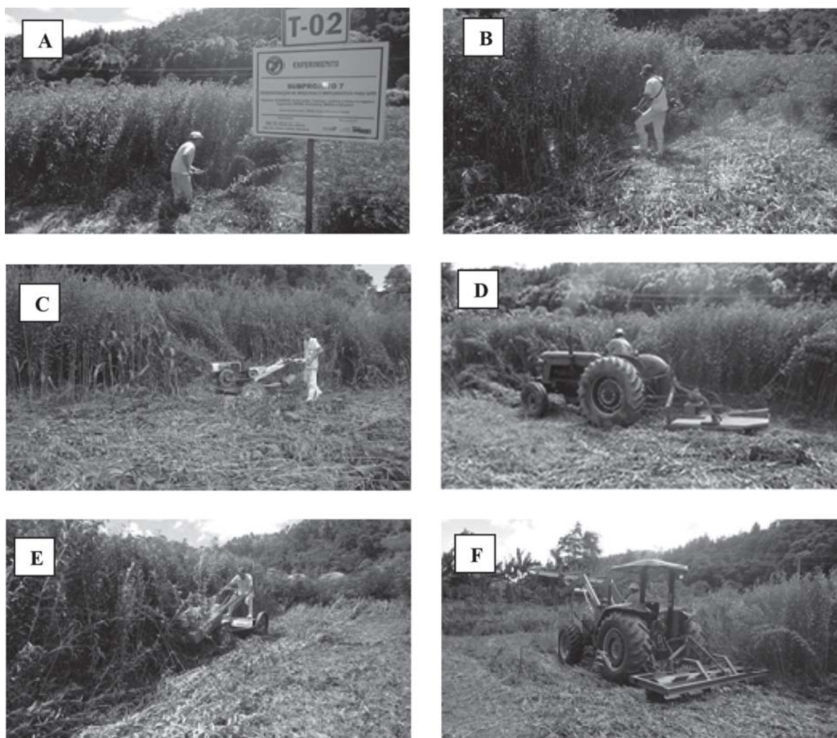
Figura 1 - Máquinas e implementos para manejo de palhada: A - Foice, B - Roçadora costal, C - Roçadora frontal de microtrator, D - Roçadora de trator, E - Rolo faca de 1,0 m, F - Rolo faca de 2,4 m.
