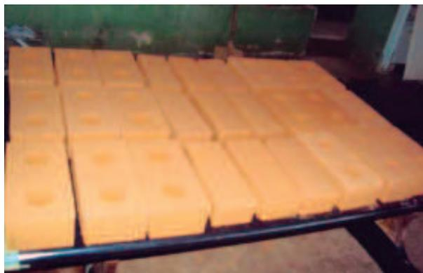
Figura 3 - Tijolos ecológicos maciços e vazados sobre a superfície de madeira.
