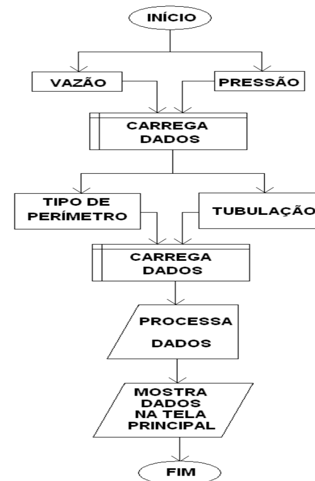
Figura 3. Fluxograma referente ao programa computacional de simulação hidráulica para perímetro irrigado GALATEIA.
