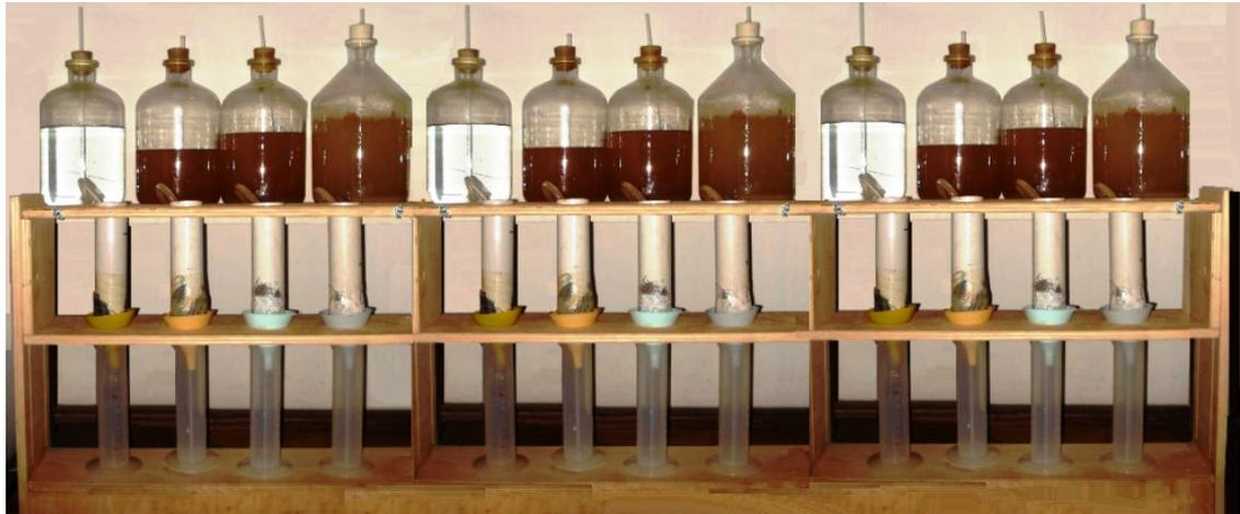
**Figura 1.** Sistema montado para estudo da remoção de metais em colunas de lixiviação.
