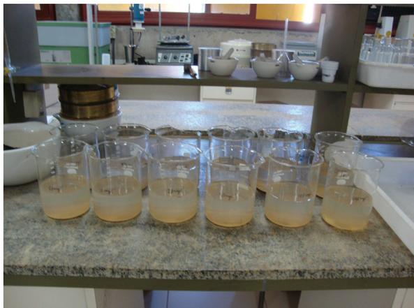
**Figura 1.** Período de repouso para decantação das amostras, contendo diferentes concentrações de potássio, após efetuado o preparo no Jar-Test.
