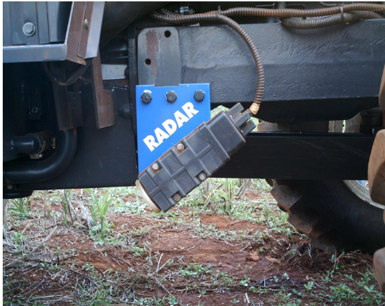
Figura 1. Radar instalado na lateral direita do trator para determinação da velocidade real de deslocamento.
