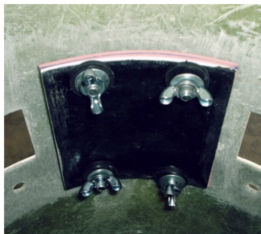
Figura 6. Fixação de um tampão do tipo B: (a) junta de borracha para vedação e (b) posicionamento no interior do tubo deslizante
