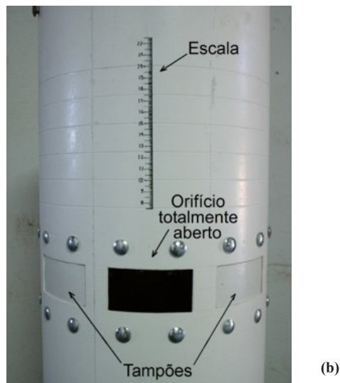
Figura 5. Tubo deslizante: (a) vista geral e (b) escala, orifícios e tampões.
