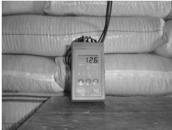
Figura 1. Termômetro digital de leitura de temperatura próximo ao bloco de sementes.
